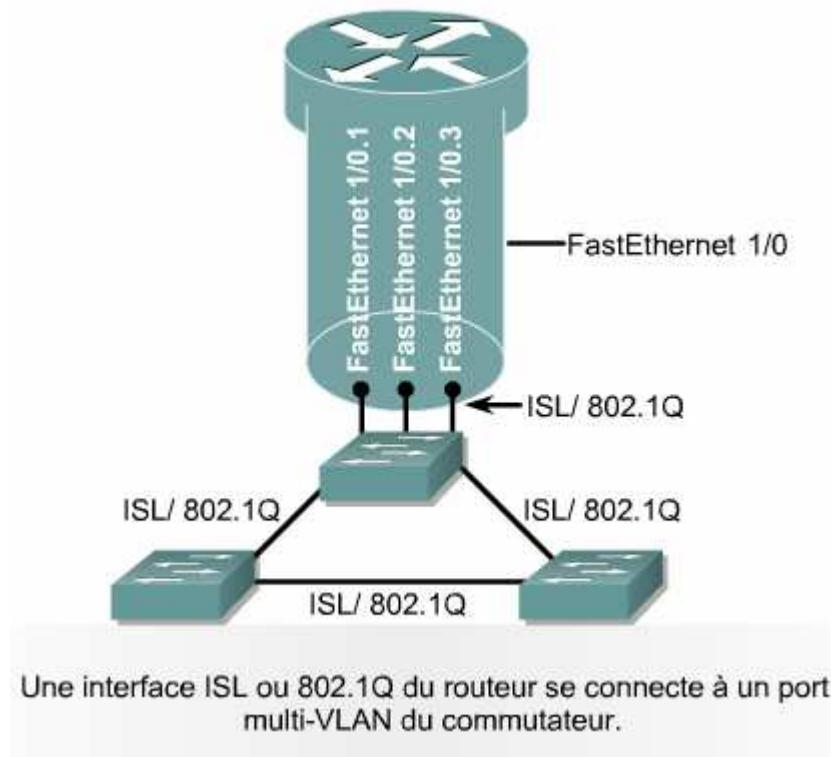
Le routeur peut prendre en charge de nombreuses interfaces logiques sur des liaisons physiques individuelles. Par exemple, l'interface Fast Ethernet FastEthernet 1/0 pourrait supporter trois interfaces virtuelles s'appelant FastEthernet 1/0.1, 1/0.2 et 1/0.3.
