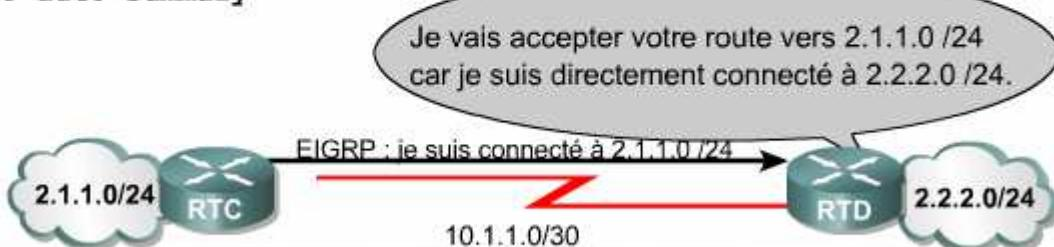
La fonction de résumé automatique empêche les routeurs d'apprendre des informations à propos des sous-réseaux non contigus. Lorsque la fonction de résumé est désactivée, les routeurs EIGRP annoncent des routes aux sous-réseaux.
