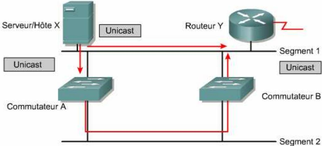
Le commutateur A ne dispose pas de l'adresse MAC du routeur Y et diffuse donc la trame sur ses ports. Le commutateur B ne connaît pas non plus le port du routeur Y. Il diffuse la trame qu'il a reçue et le routeur Y reçoit donc plusieurs copies de la même trame. Cela est le résultat d'opérations inutiles sur toutes les unités.
