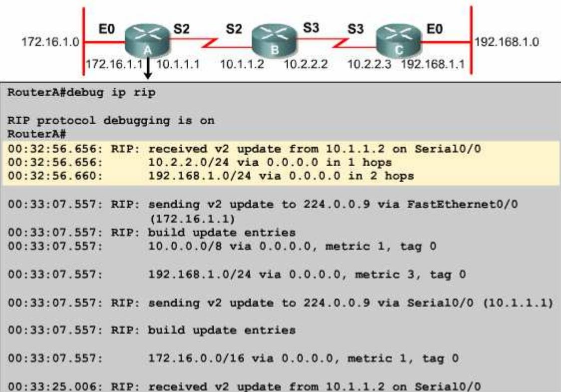
Ces messages apparaissent au démarrage ou lorsqu'un événement survient tel qu'une transition d'interface ou la réinitialisation de la table de routage par un utilisateur.
