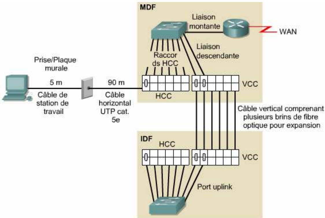
Le schéma logique représente le modèle de la topologie du réseau sans les détails relatifs au parcours d'installation précis des câbles « inclut les éléments suivants » :
