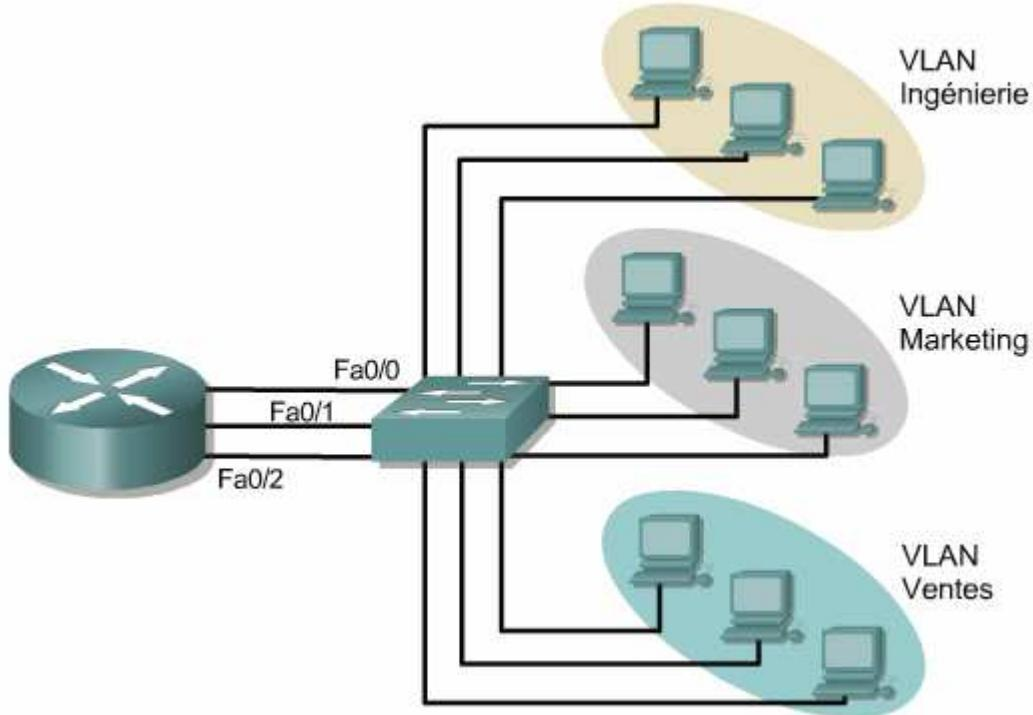
Dans cet exemple, 3 VLAN sont créés avec un routeur et un commutateur. Toutefois, il y a trois domaines de broadcast séparés. Dans ce scénario, il y a *un routeur* et un commutateur, mais *trois domaines de broadcast* séparés.
