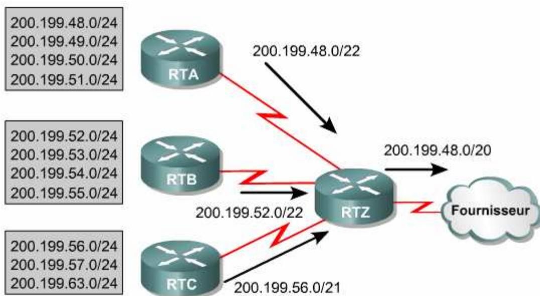
Le résumé de routes réduit la taille de la table de routage en regroupant les routes vers plusieurs réseaux en une même route SUPERNET.
