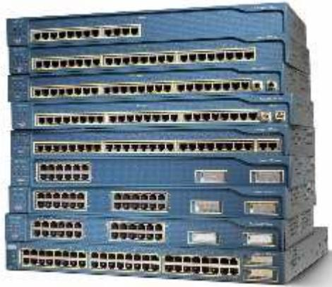
Les deux commutateurs du dessus sont des commutateurs symétriques à configuration fixes dont tous les ports sont de technologie FastEthernet ou 10/100.
