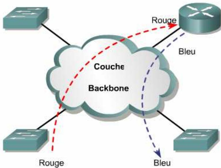
Lorsqu'un VLAN s'étend sur plusieurs équipements, une agrégation est utilisée pour interconnecter les équipements. L'agrégation transporte le trafic de plusieurs VLAN.
