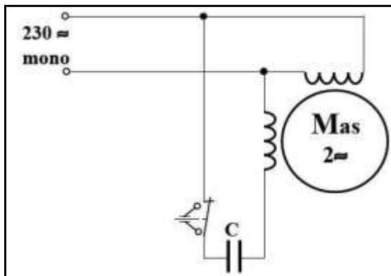
Le courant est déphasé par un condensateur de démarrage, ce qui renforce l'un des champs tournants et déforce l'autre.
