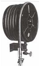
C'est un équipement de première intervention composé de tuyaux semi-rigides de 20 à 30 m enroulés sur un dévidoir tournant et pivotant, munis à leur extrémité d'une lance. Le R.I.A est un ensemble "prêt à l'utilisation", l'eau étant en permanence sous pression au robinet d'arrêt.
