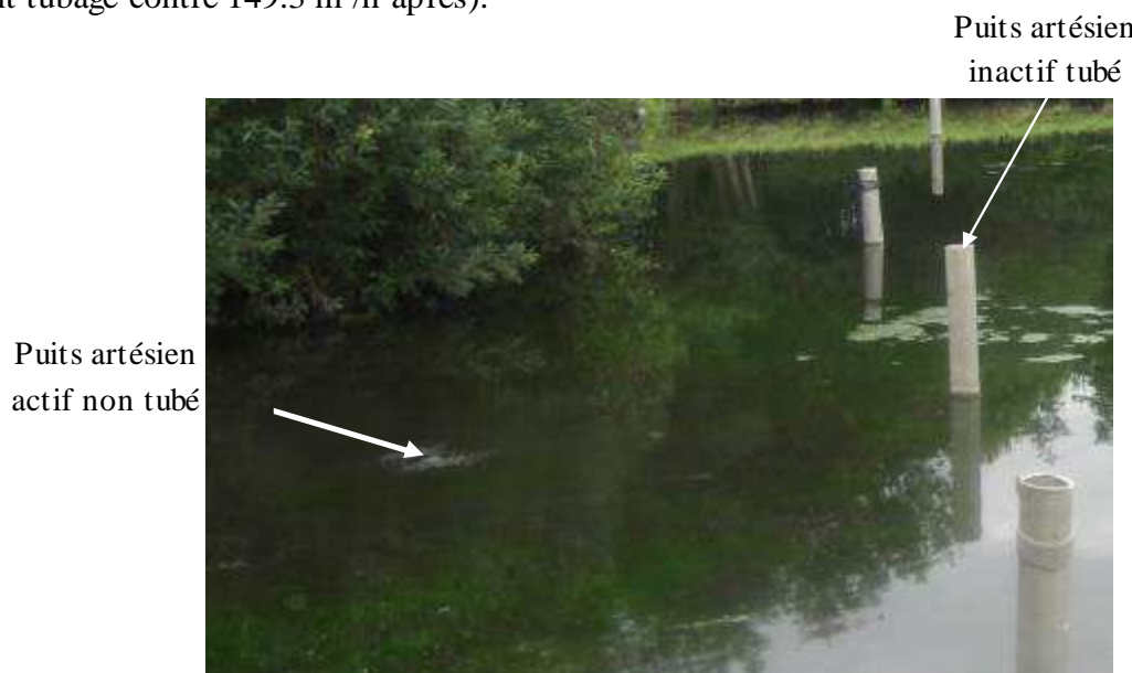
Figure 20 : Photographie illustrant le tubage d'un puits artésien actif à E
