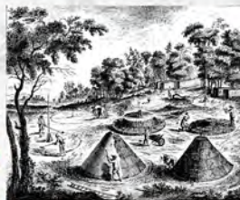
Extrait de L'Encyclopédie de Diderot et D'Alembert, Fabrication du charbon de bois vers 1750
